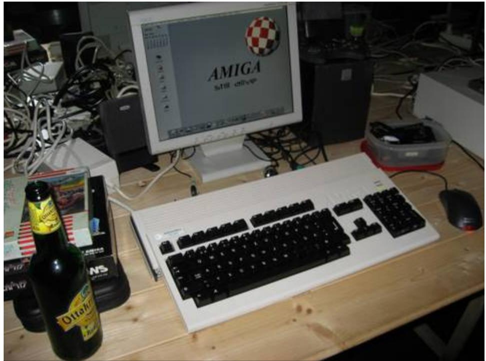
**Bild oben:** Der umgebaute und aufgerüstete Amiga 1200. Links gut zu sehen: Das Laptop-CD-Rom. Wurde schön eingebaut, leider ist das CD-Rom breiter als der A1200 an dieser Stelle. Mit schwarzen Tasten einer CDTV-Tastatur. Der ursprüngliche Plan, den gesamten A1200 schwarz zu lackieren wurde nicht umgesetzt.
