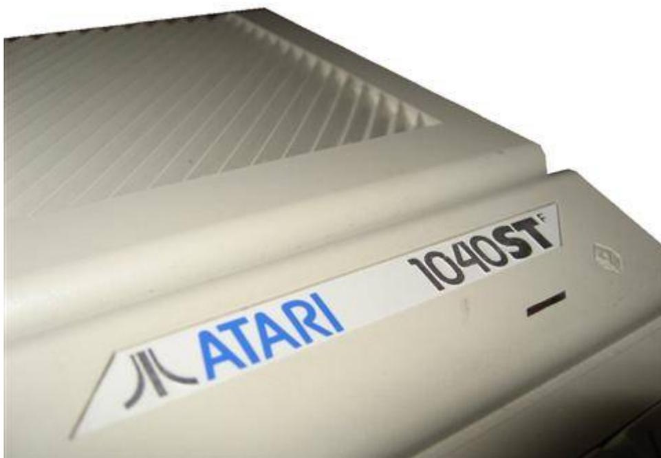
Hier das Logo des Atari 1040 STf. Er hat 1 MB RAM und das Netzteil sowie ein Laufwerk integriert. Darunter die Disk Drive LED, auch im Design vom Logo.
